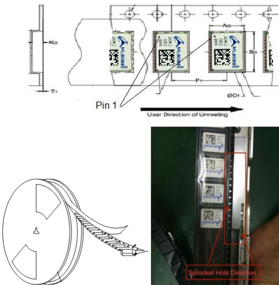
Рис.17. Направление размотки ленты и положение первого вывода приемника ML8088sE в ленте.
