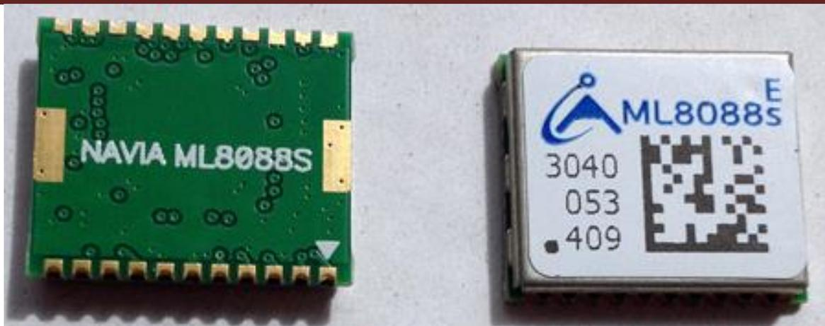
Рис. 2. Внешний вид приемника навигационного ML8088sE (не в масштабе 1:1)
