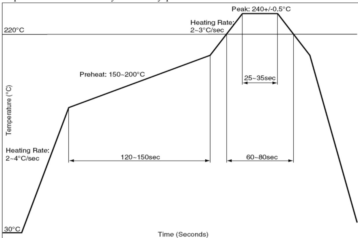
Рис. 16. Температурный профиль при пайке приемников бессвинцовыми пастами.
