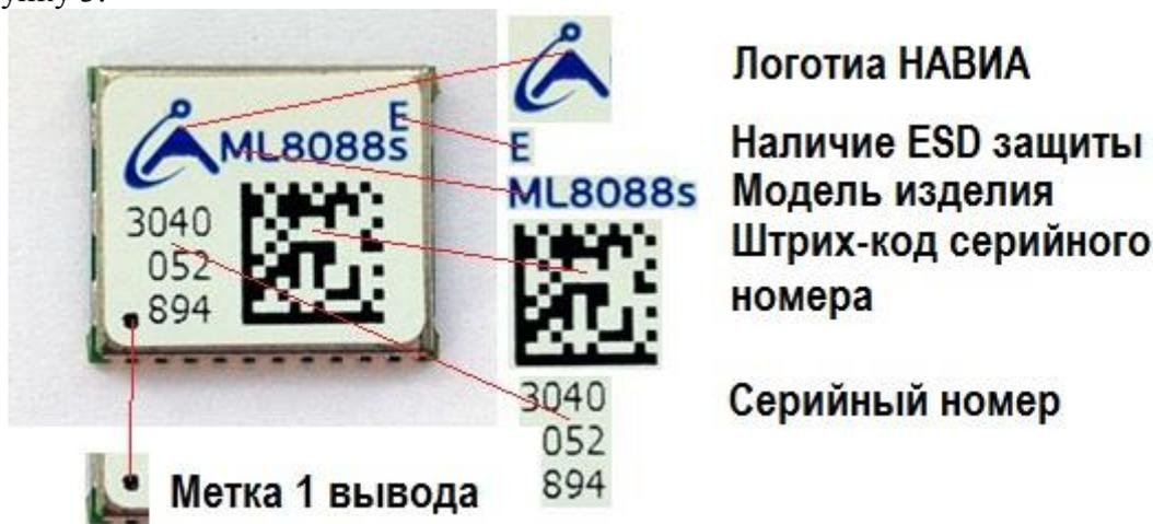
Рис. 3. Этикетка приемника навигационного ML8088sE, элементы
