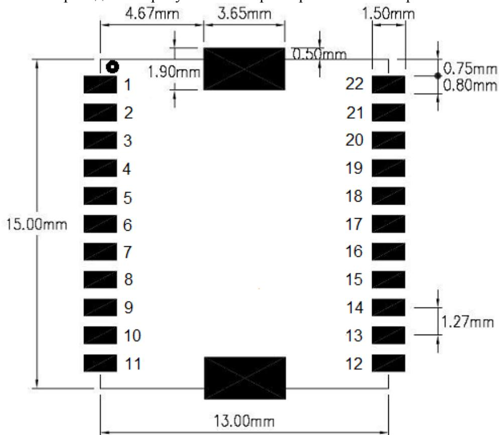
Рис.6. Рекомендуемое посадочное место для установки приемника ML8088sE.
