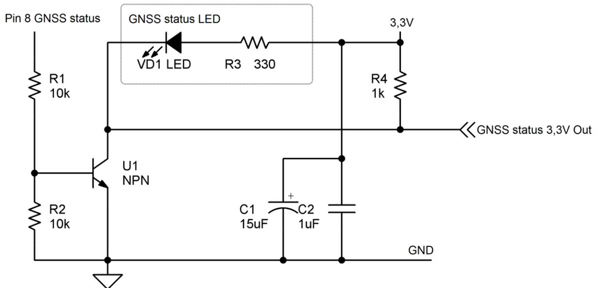
Рис.10. Типовая схема преобразования выходного уровня сигнала GNSS status приемника ML8088sE и подключения индикаторного светодиода.
